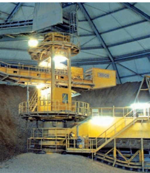
↑ Lagerung und Homogenisierung in der Scotterhalle.
